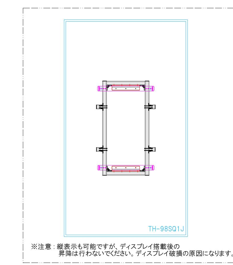
※注意: 縦表示も可能ですが、ディスプレイ搭載後の昇降は行わないでください。ディスプレイ破損の原因になります。
